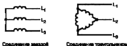
Рисунок 4 — Трехфазные трехпроводные системы
