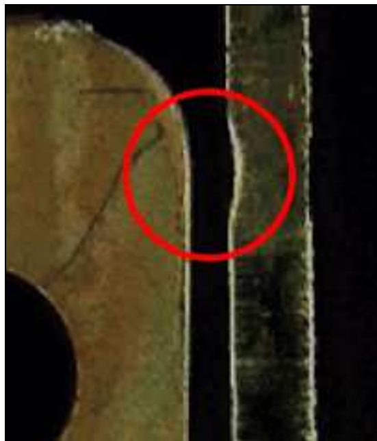
Рисунок 3. В результате длительного воздействия экстремальных вибраций контакты модульной вилки могут продавливать поверхность контактов розетки. Это явление может вызвать проблемы в передаче сигналов. (Фотография The Siemon Company)
