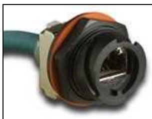
Рисунок 8. В промышленной розетке марки Siemon для сопряжения с вилкой используется байонетный механизм, обеспечивающий всей конструкции класс защиты IP 67. (Фотография The Siemon Company).
