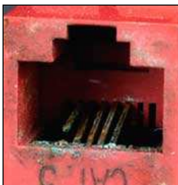
Рисунок 1. Влага корродирует контакты в розетках. Постоянное ее воздействие способно, в конце концов, полностью разрушить все контакты, делая розетку непригодной к использованию. (Фотография The Siemon Company)
